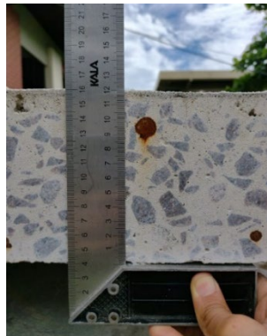
Figura 5.12 – Espessura da laje em corte (cm)
